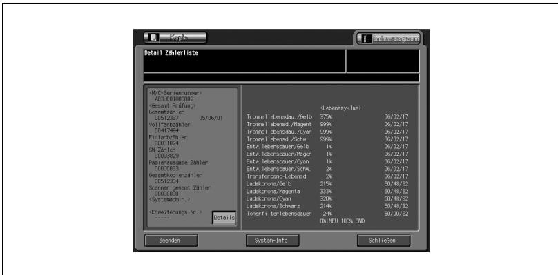
Der Produktlebenszyklus, z. B. von Fotoleitertrommel, Entwickler, Transportband, Ladeelektrode usw., wird angezeigt. Wenn die Liste nicht gedruckt werden soll, berühren Sie [Beenden], um das Bedienerprogramm zu beenden und zum vorherigen Bildschirm zurückzukehren.
